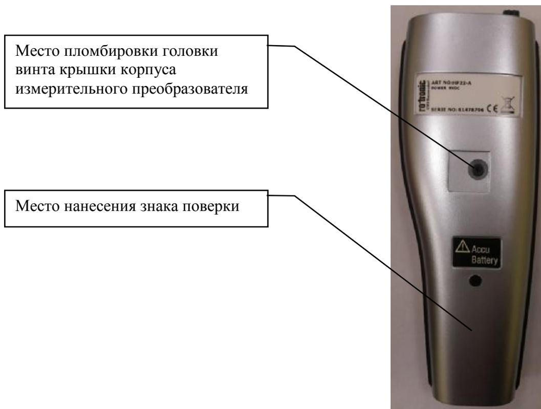
Рисунок 2 - Место нанесения знака поверки и пломбирования от несанкционированного доступа гигрометра Rotronic модификации HygroPalm
